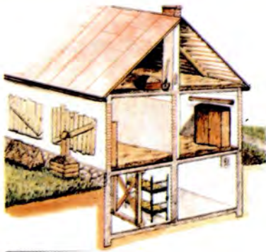
Radioaktívbiztos óvóhely a családi ház alagsorában
